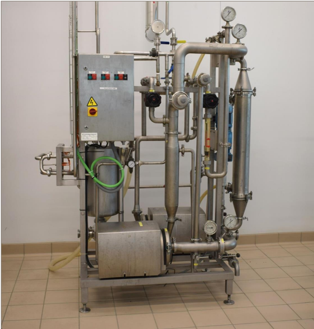
Equipo de ultrafiltración
